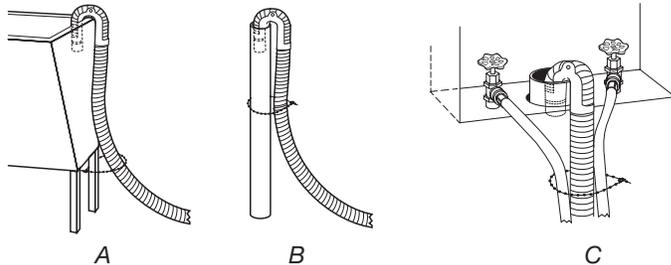
5. Si les robinets d'eau et le tuyau rigide de rejet à l'égout sont placés en retrait, introduire l'extrémité en crochet du tuyau de vidange dans le tuyau rigide de rejet à l'égout. Voir l'illustration C.
